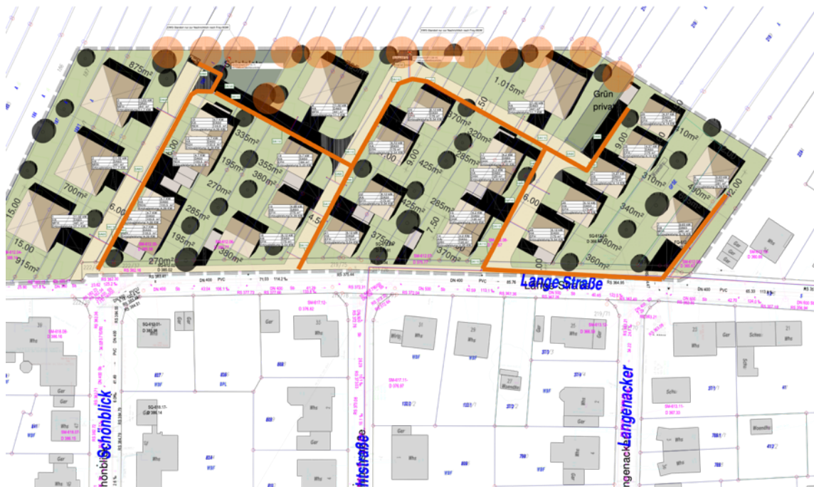
Abbildung 3: Lageplan der Quellenanlage und des Wärmenetzes, Stand 23.05.22 (© Bild: Modus Consult, Bearbeitung durch IB Reiter)
